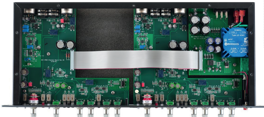
Das pieksaubere Innenleben des RPQ3 zeigt die abgesetzten beiden Vorverstärker-Sektionen sowie das Netzteil-Board.
